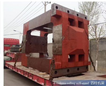
4-column rolling mill stand 四柱机架
